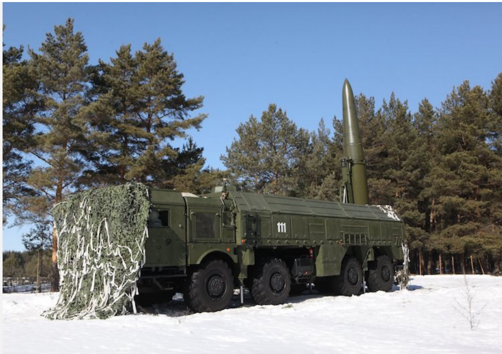
Das russische Iskander-M-Raketensystem kann Atomsprenköpfe in einer Reichweite von etwa 500 Kilometern transportieren – und es erreicht eine Zielgenauigkeit von 5 bis 7 Metern (Foto: dpa)
